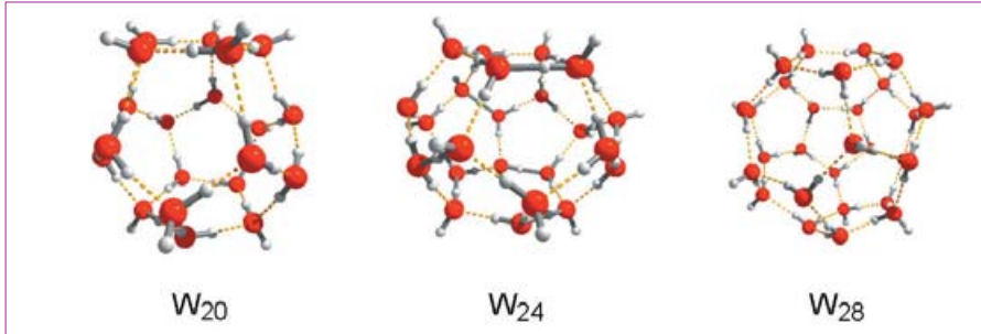
Abbildung 3: Die von Clathrathydraten bekannten Wasserkäfige: Dodekaeder, Tetrakaidekaeder und Hexakaidekaeder.
